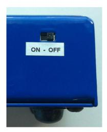
Attraverso un interruttore posto sulla parte posteriore (sul lato del connettore 25pin) è possibile disabilitare lo switchbox. Se OFF non si potrà selezionare nessun programma in quanto lo switchbox sarà disabilitato, caso contrario invece se ON. I pulsanti OK – ESC – RESET funzionano in entrambi i casi.
